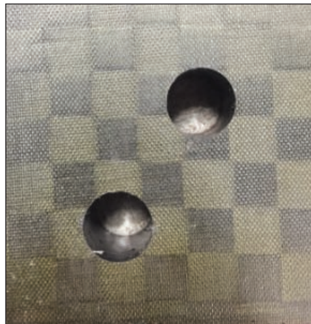
用Allied的T-A®PCD刀片鑽出的孔
