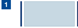
1 Fräsen von glatten Platten 2 x nur kurze Seiten – lange Seiten bleiben roh Milling of plain plates 2x short sides only – long sides remain raw
