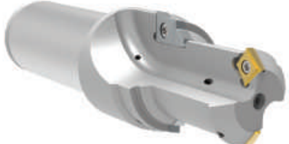
正方形QDSI 34°刀片 和i-Form刀片
