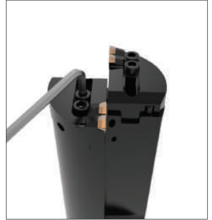
第3步： 将刀夹上的安装螺钉拧紧至11-14 ft-lbf (15-19 N-m)。
