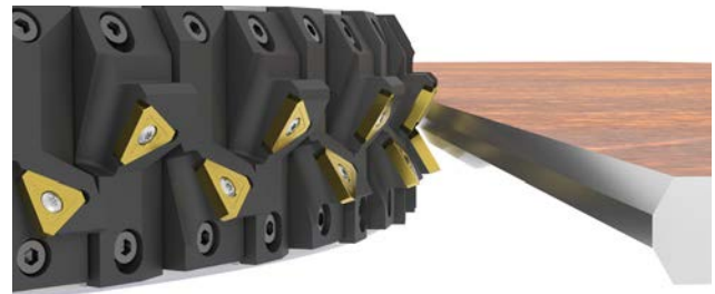
I + V-Profil = X-Profil mit 2 seriellen Fräsern I + V-profile = X-profile with 2 serial cutters
